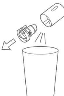
3. Istresite ciklonski separator iznad kante za đubre kako biste istresli prašinu, kao što je prikazano na slici. Ispraznite sadržaj odeljka za prašinu I očistite svu prašinu sa ciklonskog separatora.
