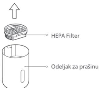
2. Izvadite HEPA filter iz odeljaka za prašinu kao što je prikazano na slici I uklonite prašinu sa njegove površine.
